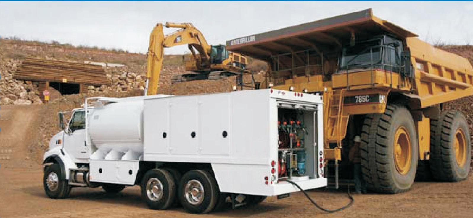
移动油脂加注车是一种车载式可移动润滑油脂集中加注站，由动力站（空压/液压）、储油系统（稀油、干油、清洗液、防冻液等）和加注系统（泵、卷管器、计量加注枪等）组成，可向设备加注马达油、齿轮油、清洗液、防冻液、液压油、油脂等流体。动力站通过柴油机车或外接能源向泵提供动力，可向分散的、移动的工程机械加注各种润滑油脂，同时具备分装油脂和清洁车辆的功能。
